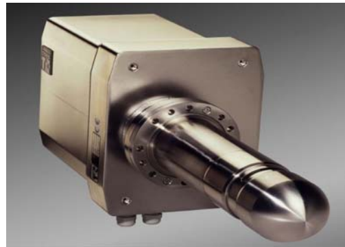
Fig. 4 OPUS system: sensore ultrasonoro per l'analisi delle dimensioni delle particelle presenti in emulsioni e sospensioni concentrate tra i 10 nm e i 3 mm ( https://www.sympatec.com ).
